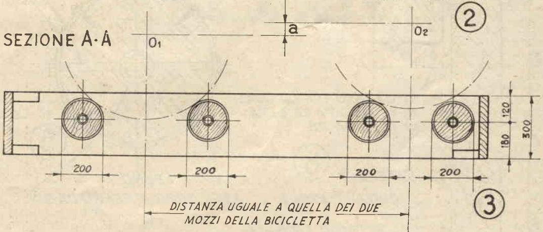
preparati, andranno fissati alle estremità dei cilindri, come se fossero dei fondi di recipienti, con l'aiuto di diverse viti a legno passate attraverso fori appositamente praticati nelle pareti dei cilindri; poi, per rendere solidali i cilindri di ferro all'asse, come è necessario, specialmente nel caso dei rulli 1°, 2° e 3°, si fa ricorso al sistema della barretta filettata impegnata alle sue estremità, sulle pareti del
