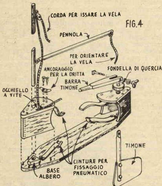
cale, va fatta una fenditura di adatta larghezza. Per il fissaggio serve una vite a galletto da 6 mm. che permetterà in qualsiasi momento lo smontaggio del timone allorché occorrerà trasportare l'imbarcazione, in modo che occupi il minimo spazio.
