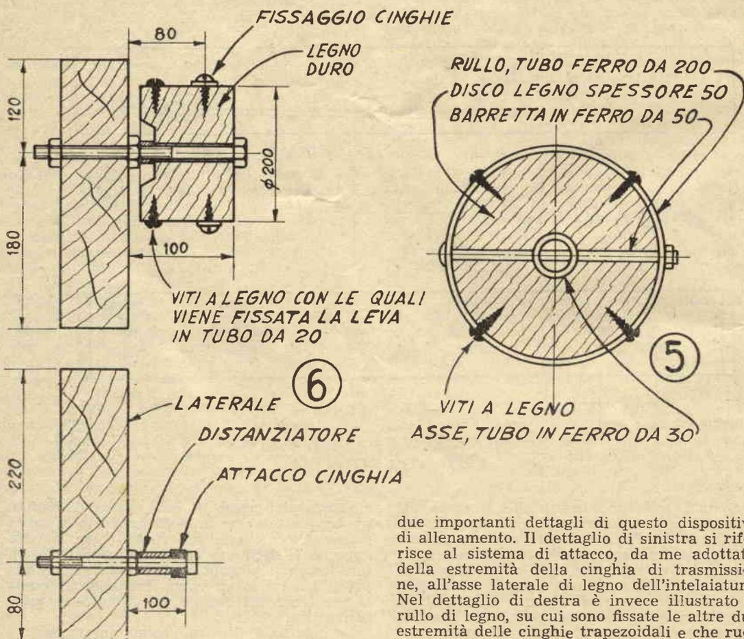
due importanti dettagli di questo dispositivo di allenamento. Il dettaglio di sinistra si riferisce al sistema di attacco, da me adottato, della estremità della cinghia di trasmissione, all'asse laterale di legno dell'intelaiatura. Nel dettaglio di destra è invece illustrato il rullo di legno, su cui sono fissate le altre due estremità delle cinghie trapezoidali e che ruo-
