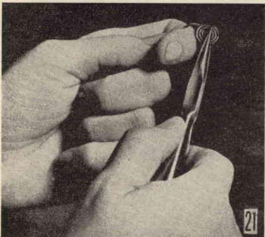
Foto 21: Attorno all'occhiello iniziale si avvolge poi la spirale, in piccoli tratti trattenendola nel frattempo quasi tutta nella pinza e facendola man mano ruotare.
